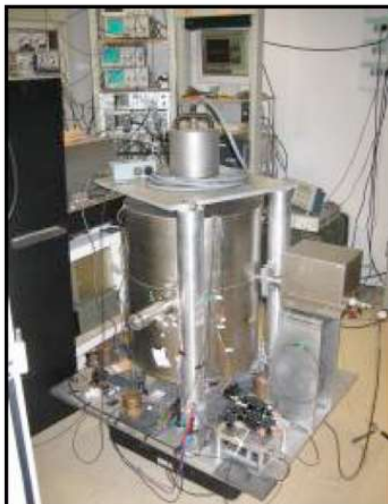
Paris Gravimeter („mobile“) Achieved Accuracy: 1.4 \cdot 10^{-8} \text{ g}
